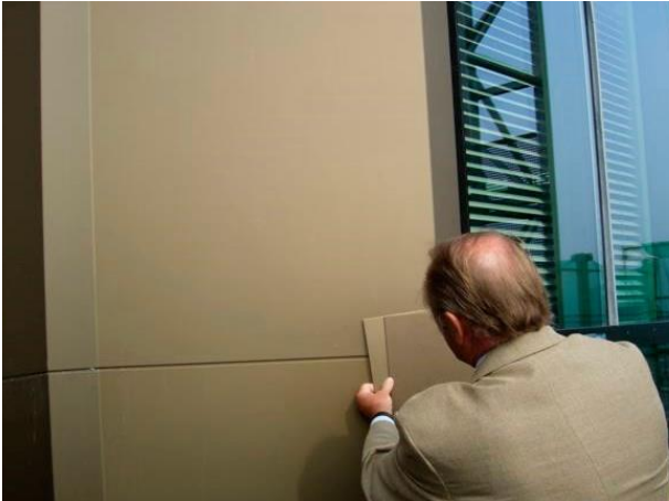
Abbildung 2 – Abgleich eines anodisierten Aluminiumblechs mit den vereinbarten Grenzmustern „dunkel“ und „hell“
